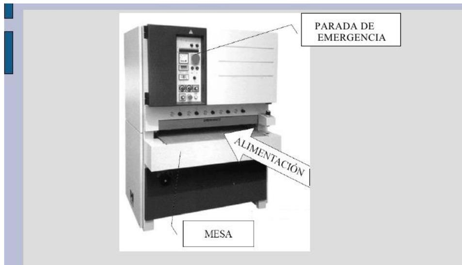
Figura 8. Partes de la Lijadora industrial de banda ancha
