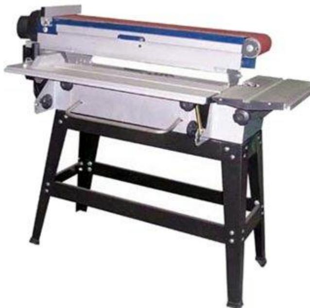
**Figura 5. Lijadora de banda industrial horizontal y vertical**
