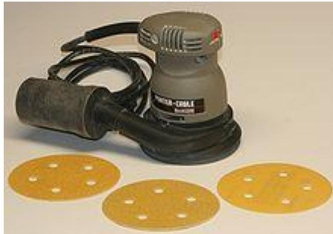
Figura 22. Lijadora orbital y accesorios
