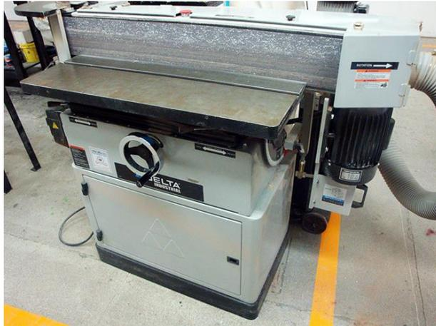
Figura 11. Lijadora eléctrica industrial oscilante
