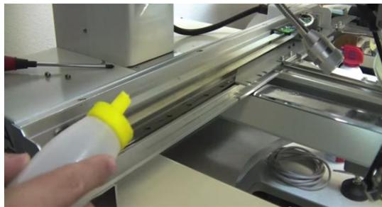
*Figura 81.* Aceitado del pantógrafo
