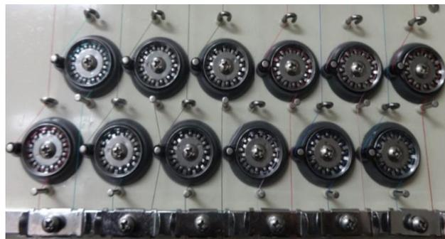
*Figura 44.* Sensores de rotura de hilo
