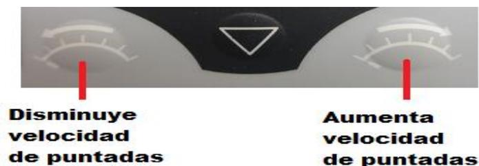
Figura 58. Teclas control de velocidad
