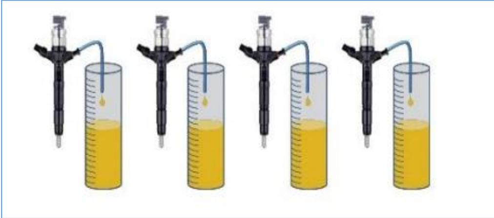
*Figura 56.* Prueba de retorno. Fuente: Recuperado de <https://es.slideshare.net/tquisant/sistema-a-de-inyeccin-common-rail-promcytec>
