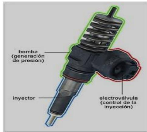
Figura 23. Inyector. Fuente: Recuperado de <https://tallerescuencia.com/inyector-bomba/>
