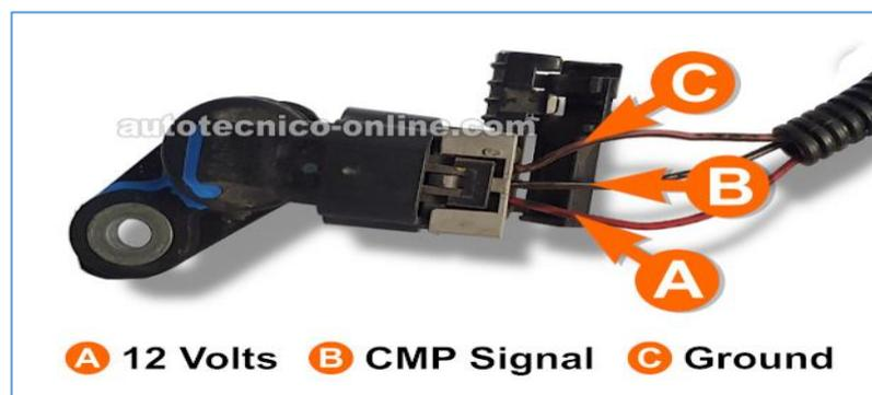
Figura 46. Designación de los pines del sensor CMP. Fuente: Recuperado de <https://autotecnico-online.com/gm/4.2L/probando-el-sensor-del-arbol-de-levas-2>
