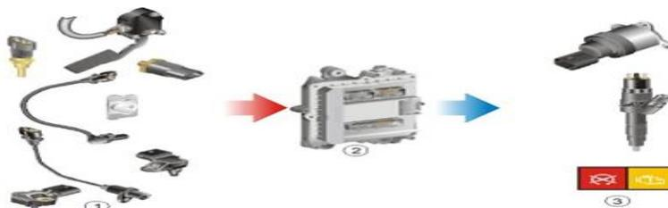
Sensores auxiliares (1); Unidad de comando (2); Actuadores auxiliares (3).
