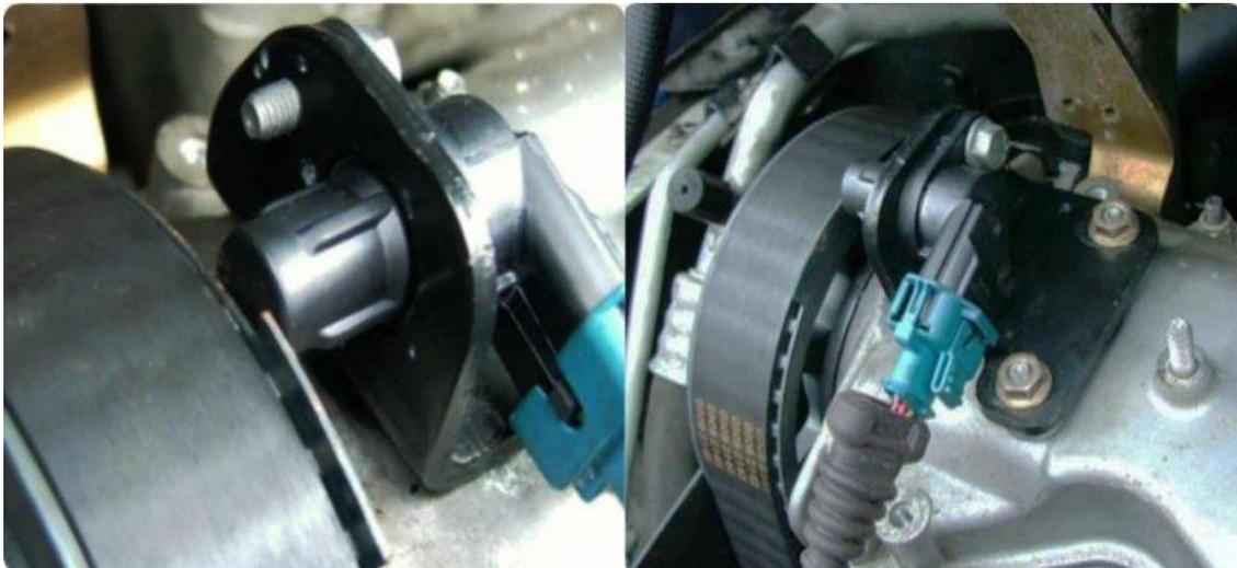
Figura 45. Sensor CMP. Fuente: Recuperado de <https://www.soloparamecanicos.com/sensor-cmp/>
