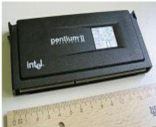
*Figura 21.* Microprocesador Intel Pentium II.
