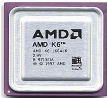
Figura 20. Microprocesador AMD K6.
