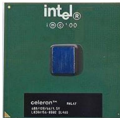
Figura 23. Microprocesador Intel Celeron.
