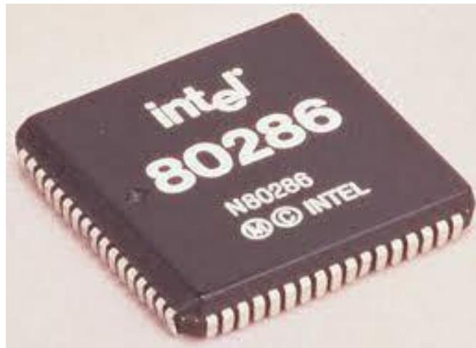
*Figura 10.* Microprocesador Intel 80286. Fuente: Recuperado de <https://concepto.de/microprocesador/78>
