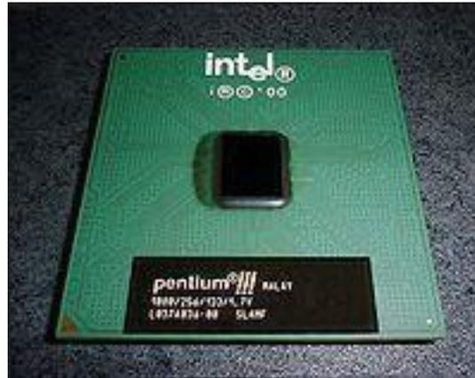
Figura 25. Microprocesador Intel Pentium III. Fuente:
