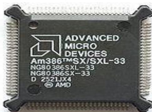
*Figura 14.* Microprocesador AMx86. Fuente:
