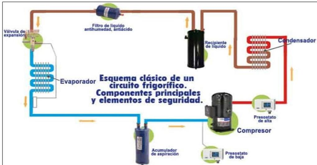
Figura 14. Esquema frigorífico. Fuente: Recuperado de <https://www.tecnologia-industrial.es/tecnologiaindustrial/maquinas-frigorificas/>
