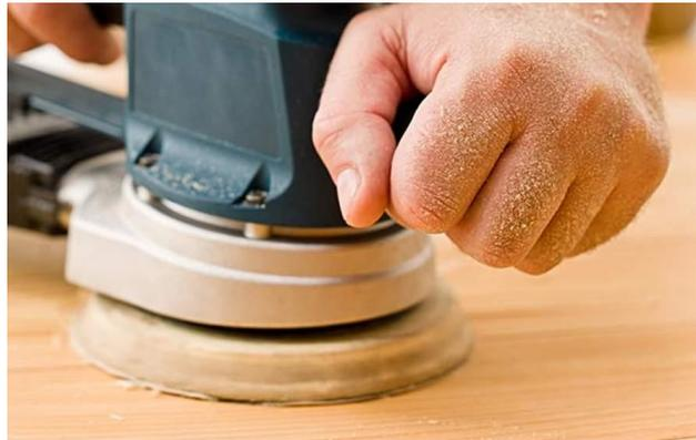
Ilustración 36 Lijadora Orbital
