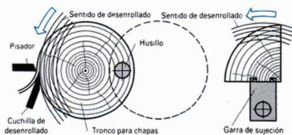
**Fig. 2. Obtención de chapas por desenrollado excéntrico.**
