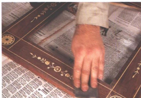
Ilustración 93 Lijado Manual tras el Barnizado
