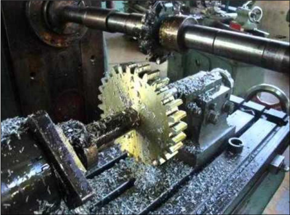
*Figura 37.* Fresado de engranajes. Fuente: <http://www.directindustry.es/prod/tos-as/product-84955-1154759.html>
