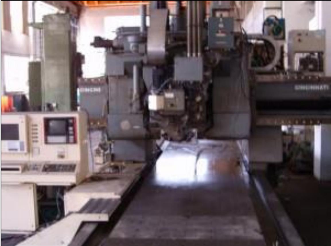
*Figura 16.* Fresadora de pórtico. Fuente: <https://pyrosisproyect.wordpress.com/2011/09/08/por-la-orientacion-del-eje-de-giro/>
