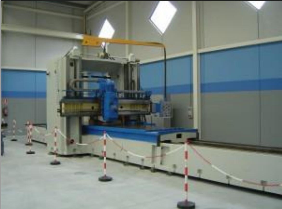
*Figura 17.* Fresadora de puente móvil. Fuente: [https:// pyrosisproject.wordpress.com/2011/09/08/por-la-orientacion-del-eje-de-giro/](https://pyrosisproject.wordpress.com/2011/09/08/por-la-orientacion-del-eje-de-giro/)
