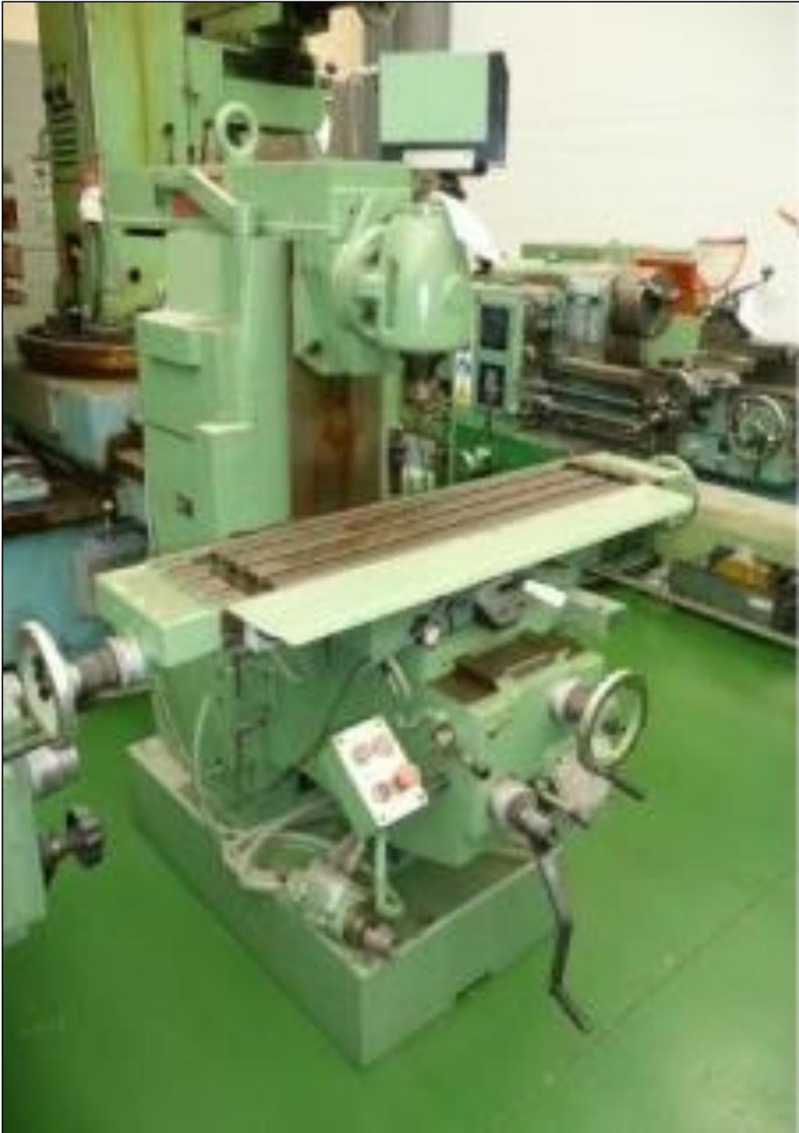
*Figura 12.* Fresadora universal. Fuente: <https://pyrosisproject.wordpress.com/2011/09/08/por-la-orientacion-del-eje-de-giro>
