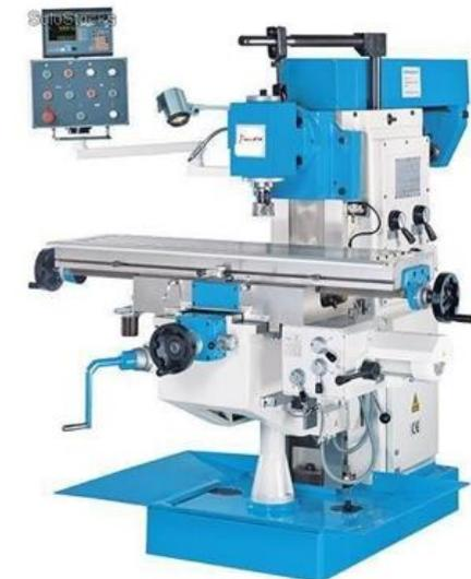
banco fijo o de bancada y la segunda responde al nombre de fresadoras de torreta o de consola. En una fresadora de torreta, el husillo se mantiene estacionario en el tiempo que ocurren las operaciones de corte y la mesa se mueve tanto horizontalmente como verticalmente. Mientras que, en las fresadoras de banco fijo, la mesa se mueve solo perpendicularmente al husillo, mientras que el husillo en sí se mueve en dirección paralela a su propio eje.
