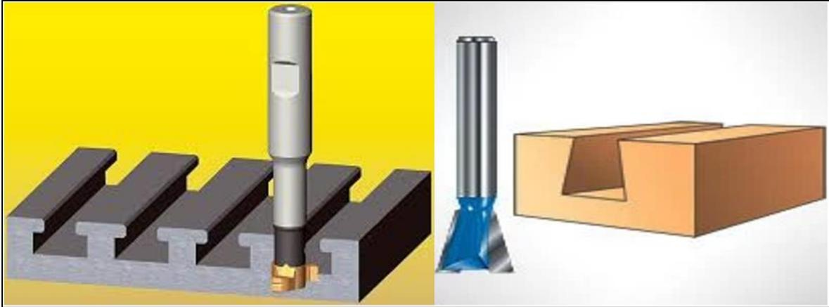
Figura 28. Formas de T y cola de milano. Fuente: <http://pyrosisproyect.wordpress.com/2011/09/>
