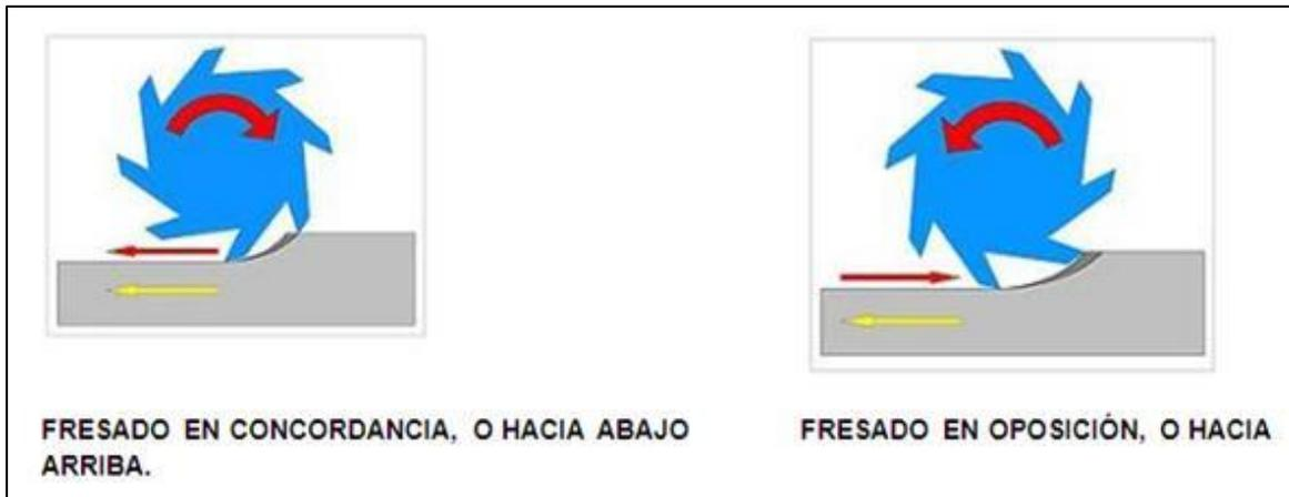
Figura 39. Procedimiento de fresado. Fuente: <http://www.monografias.com/trabajos104>
