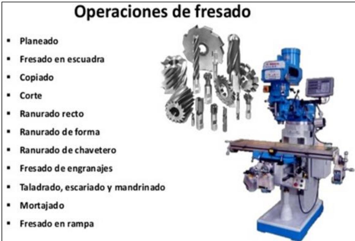
Figura 20. Operaciones de fresado. Fuente: <https://www.slideshare.net/juanjoserodriguezdiaz/mquinas-fresadoras-y-rosca>.
