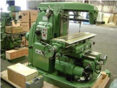
entalladura, ranuras, dentado, y más. Adicionalmente, con toda pieza fresada se tiene la posibilidad de ser desbastadas o afinadas. En caso de fresadoras convencionales, las piezas son acercadas a las zonas de corte (fresa), para poder producir diversas formas desde superficies planas u otras más complejas.
