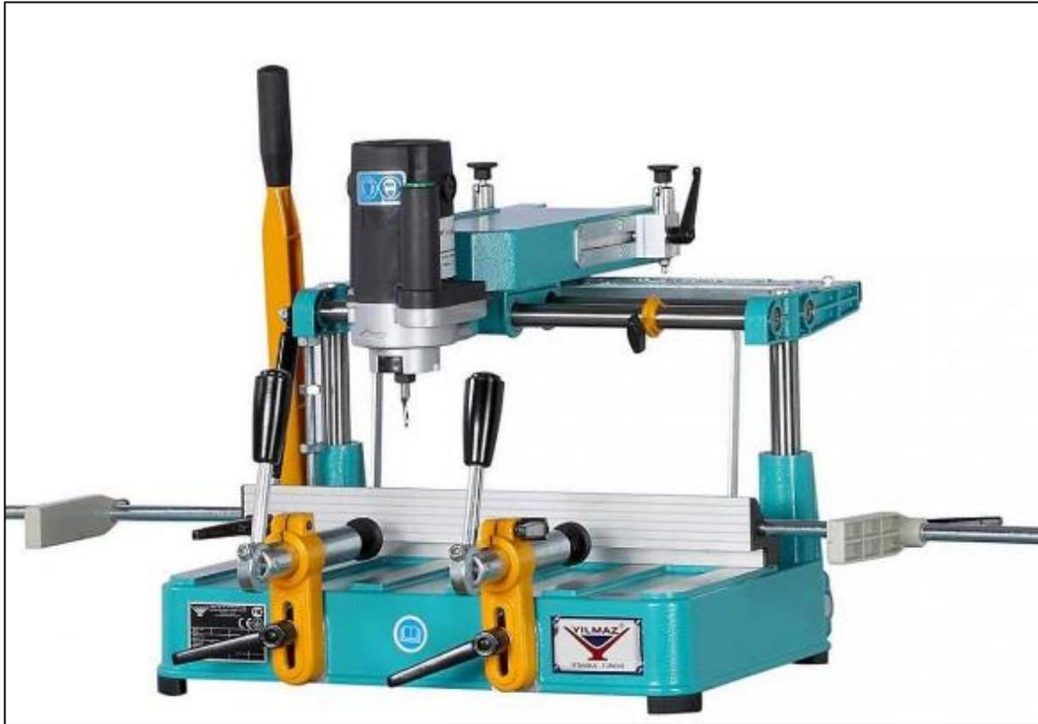
*Figura 15.* Fresadora copiadora para aluminio. Fuente: <http://www.directindustry.es/prod/yilmaz-machine/product-161948-1677378.html>
