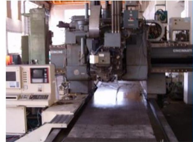
Dentro de este tipo de máquinas existen algunos modelos que cuentan además con un par de cabezales horizontales, ubicados uno a cada lado de la mesa, cuyo desplazamiento es vertical. No obstante, sus ejes describen un desplazamiento horizontal. Lo mencionado, permite que este modelo posea un gran número de movimientos, dándole mayor libertad y mayores posibilidades de labrado de piezas.
