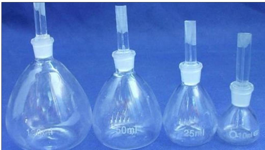
Figura 3. Picnómetro. Fuente: Recuperado de <https://www.testmak.com/es/picn%C3%B3metro-para-la-botella-de-gravedad-espec%C3%ADfica>
