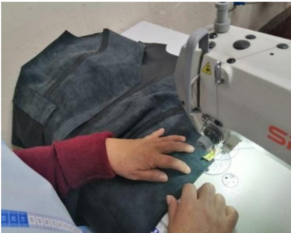
*Figura 44.* Preparación y colocación del forro con las vueltas espalda y delantero. Fuente: Autoría propia
