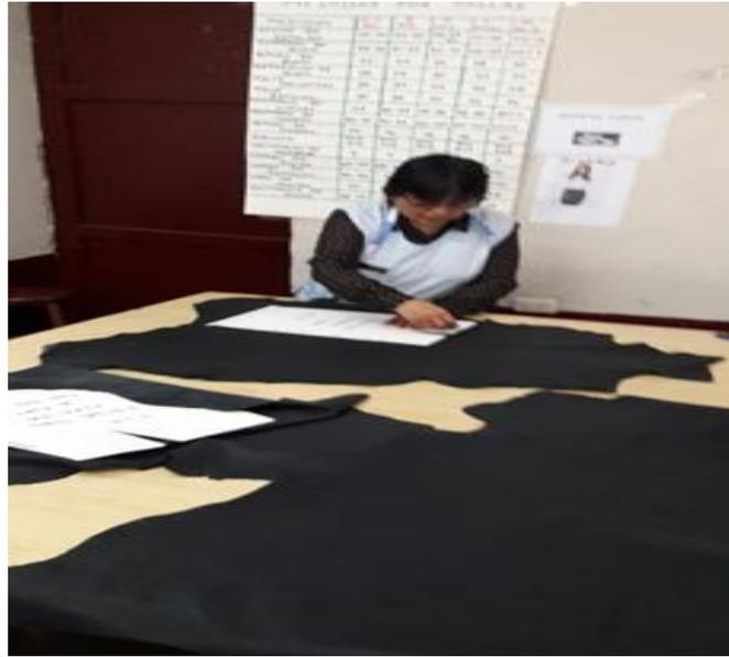
*Figura 32.* Colocación de los moldes de la falda sobre el cuero.
