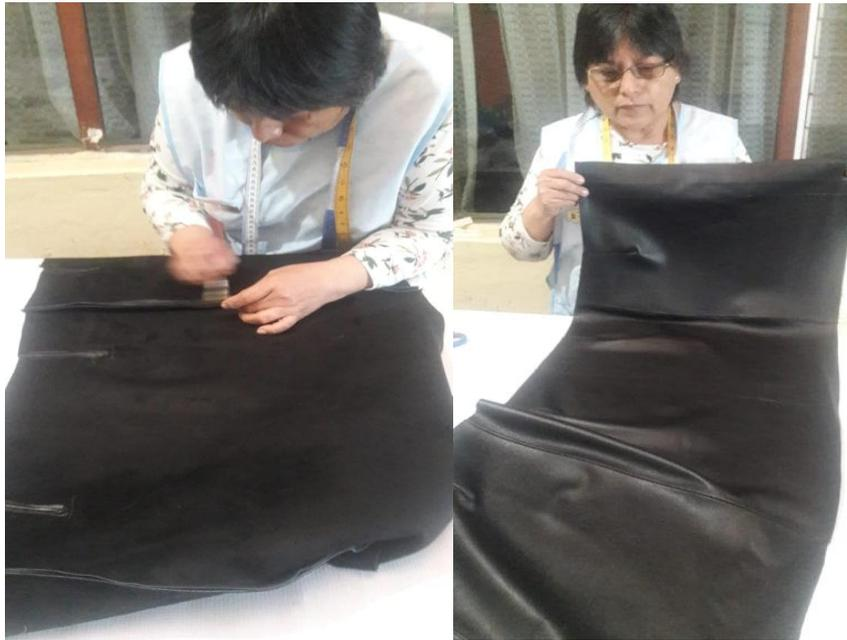
Figura 35. Unión de los costados delantero, espalda falda y planchado. Fuente: Autoría propia
