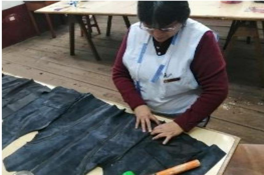
*Figura 43.* Cosido y pegado de los costados delantero y espalda. Fuente: Autoría propia
