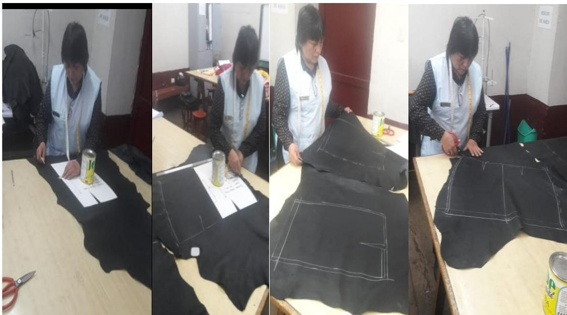
*Figura 33.* Marcado y corte de las piezas de la falda. Fuente: Autoría propia
