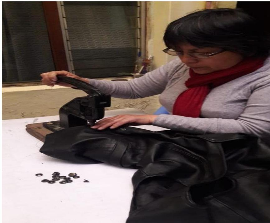
Figura 46. Colocación de los broches con la máquina a presión. Fuente: Autoría propia
