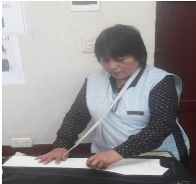
Figura 40. Colocación del molde patrón sobre el cuero. Fuente: Autoría propia
