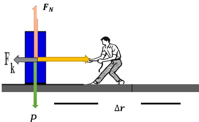
*Figura 5.* Fuerzas internas y externas que actúan sobre el sistema a lo largo del desplazamiento  $\Delta r$ . Cuando el objeto se desplaza horizontalmente sobre el piso las  $F_N$  y el  $P$  no realizan ningún trabajo.
