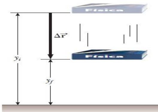
*Figura 12.* El trabajo utilizado por la fuerza ejercida por la gravedad en el proceso que el libro cae de  $y_i$  a una altura  $y_f$  es Igual a  $mgy_i - mgy_f$ . Tomado de *Física para ciencias e ingeniería* de Serway & Jewett (2008, México D.F, p.177)
