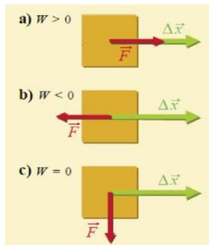
*Figura 6.* Si  $F$  tiene la misma dirección que  $\Delta r$ , el  $W > 0$ . si  $F$  tiene dirección opuesta al  $\Delta r$ , el  $W < 0$ . Si  $F$  es perpendicular a  $\Delta r$ , el  $W = 0$ .
