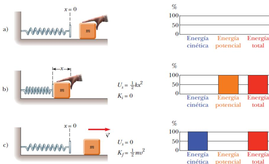
Figura 13. Energía potencia de las fuerzas elásticas en su estado natural, comprimido y deformado, tomado de *Física para ciencias e ingeniería* de Serway & Jewett (2008, México D.F, p.180).
