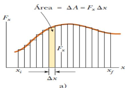
Figura 9. El trabajo consumido en una partícula por la componente de fuerza  $F_x$  para el desplazamiento pequeño  $\Delta x$  es  $F_x \Delta x$ , que es igual al área del rectángulo sombreado. El Trabajo total consumido por el desplazamiento de  $x_i$  a  $x_f$  es aproximadamente igual a la suma de las áreas de todos los rectángulos.
