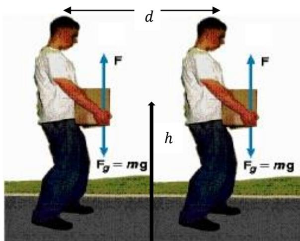
Figura 7. Una persona eleva una caja pesada de masa  $m$  una distancia vertical  $h$ , en seguida camina horizontalmente con velocidad constante una distancia  $d$ , tomado de *Física I texto basado en cálculos* de Serway & Jewett (2004, México, p.181).
