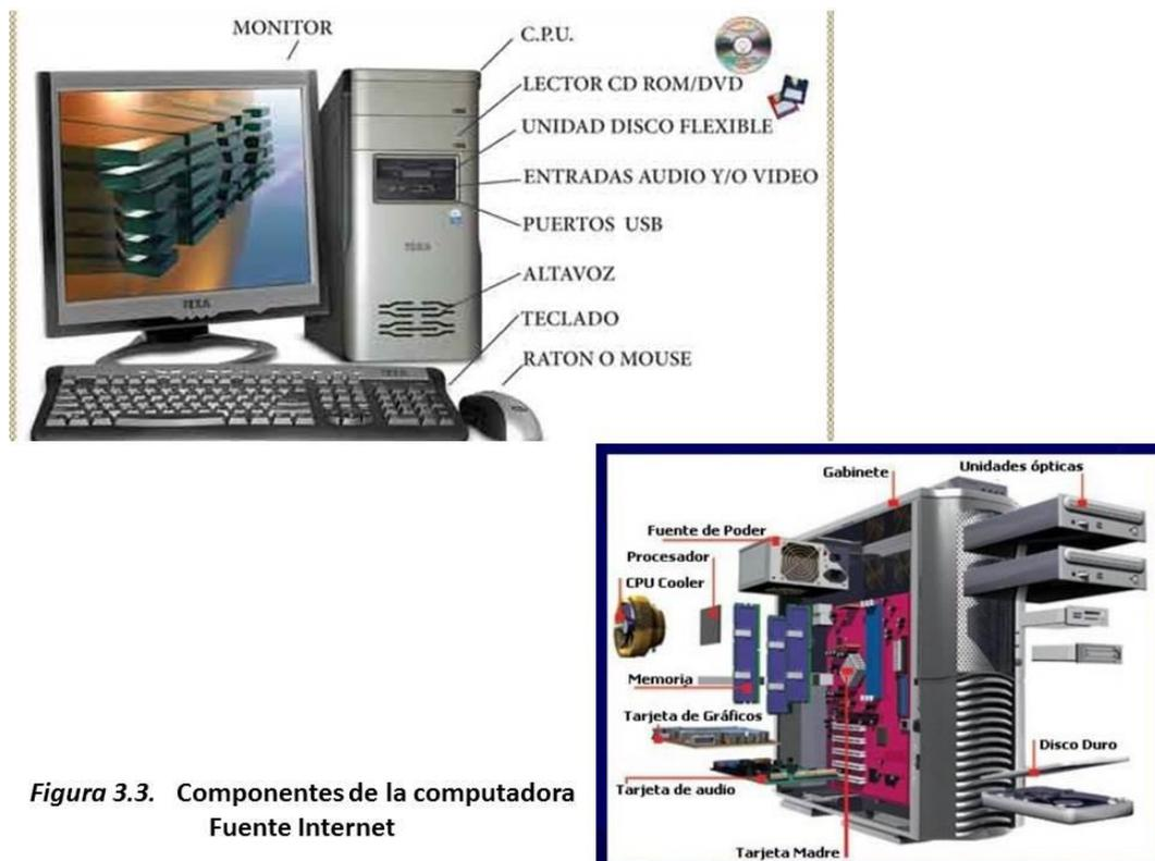
**Figura 3.3.** Componentes de la computadora
