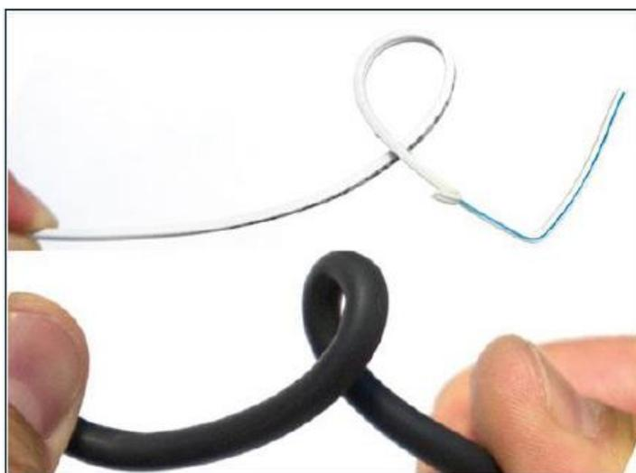
Figura 5. Manejo indebido del cable.
