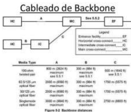
Figura 5. Cableado de Backbone
