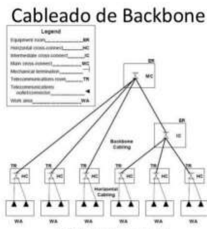
Figura 4. Estándares del cableado de BACKBONE
